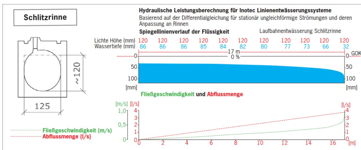
Für unsere Schlitzrinnen LW 125 liegt die optimale Fließlänge bei ca. 17 m, mit einer Auslastung zwischen 70 und 80 %. Bei einer 400 m Bahn mit gleichmäßiger Aufteilung sind dafür 12 Einlaufkästen erforderlich. Bei einem Abstand von ca. 34 m erhält man 24 Teilstränge von ca. 17 m (Fließrichtung jeweils von beiden Seiten zum Einlaufkasten). Aus der ermittelten Zulaufmenge von 0,216 l/s und der Rinnenlänge von 34 m ergibt sich eine Abflussmenge von ca. 7,4 l/s je Einlaufkasten.
