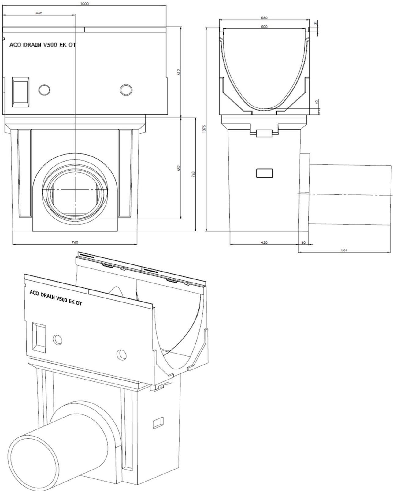
ACO DRAIN Multiline Rinnensystem für die Verwendung in LAU-Anlagen
