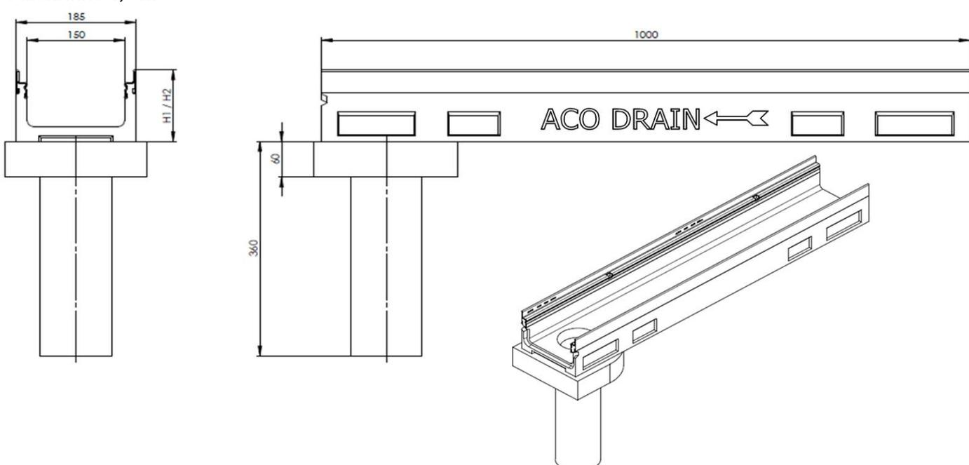
ACO DRAIN Multiline Rinnensystem für die Verwendung in LAU-Anlagen
