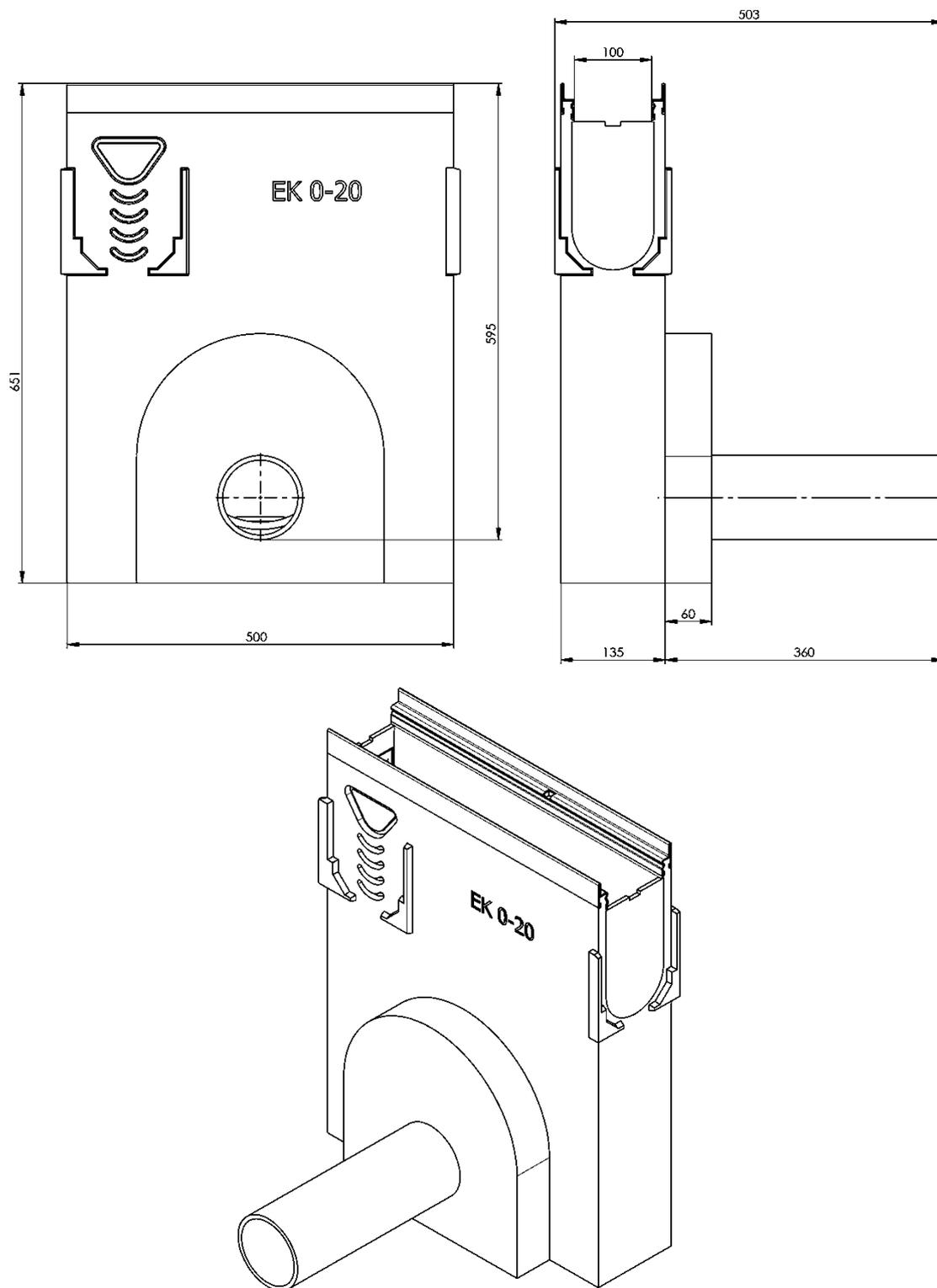
ACO DRAIN Multiline Rinnensystem für die Verwendung in LAU-Anlagen
