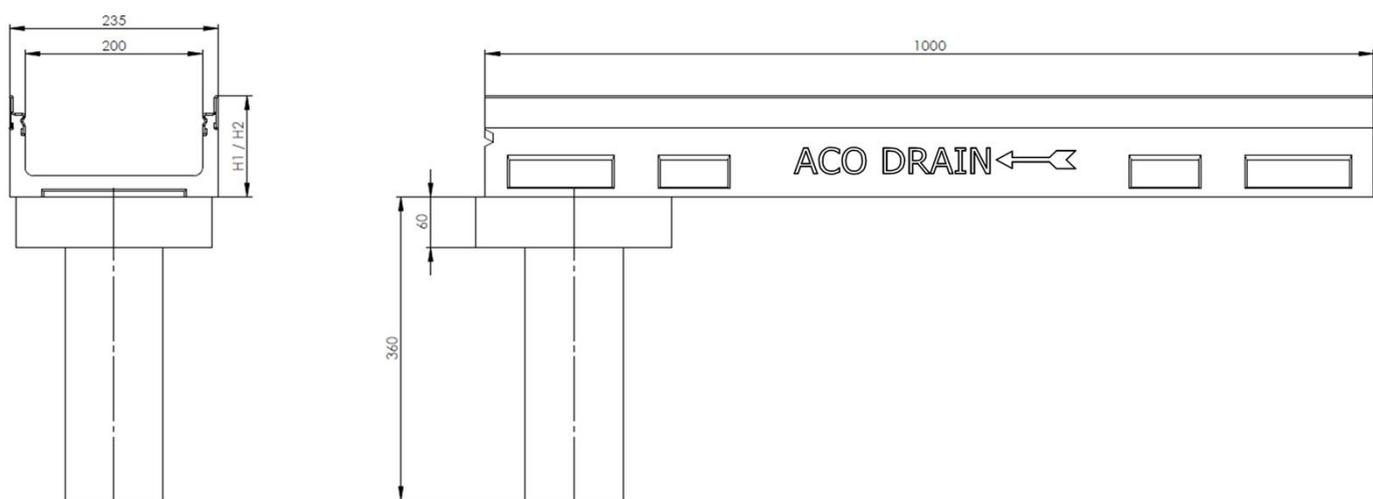
ACO DRAIN Multiline Rinnensystem für die Verwendung in LAU-Anlagen
