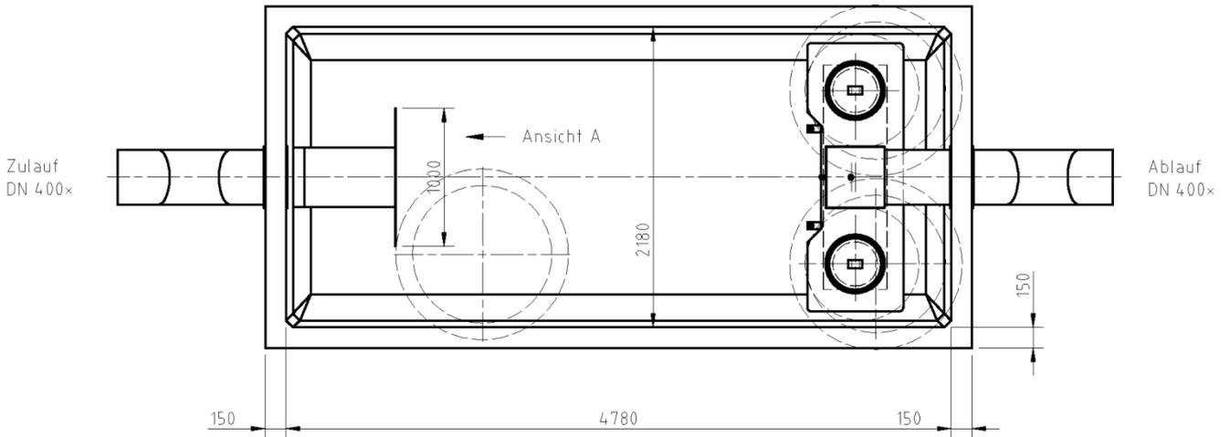
× Anschlüsse nach DIN 19534/19537 und DIN EN 877
