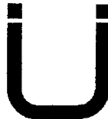
Vereinfachtes Zeichen zur Kennzeichnung auf Baustoffen, Bauteilen und Einrichtungen, wenn der Lieferschein das Überwachungszeichen nach Abb. 1 trägt. Dabei soll der Fremdüberwacher durch ein – ggf. vereinfachtes – Zeichen erkennbar sein.
