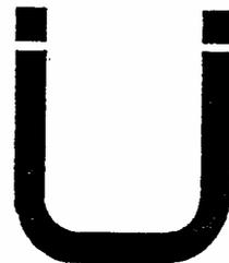
Vereinfachtes Zeichen zur Kennzeichnung auf Baustoffen, Bauteilen und Einrichtungen, wenn der Lieferschein das Überwachungszeichen nach Abb. 1 trägt. Dabei soll der Fremdüberwacher durch ein – ggf. vereinfachtes – Zeichen erkennbar sein.
