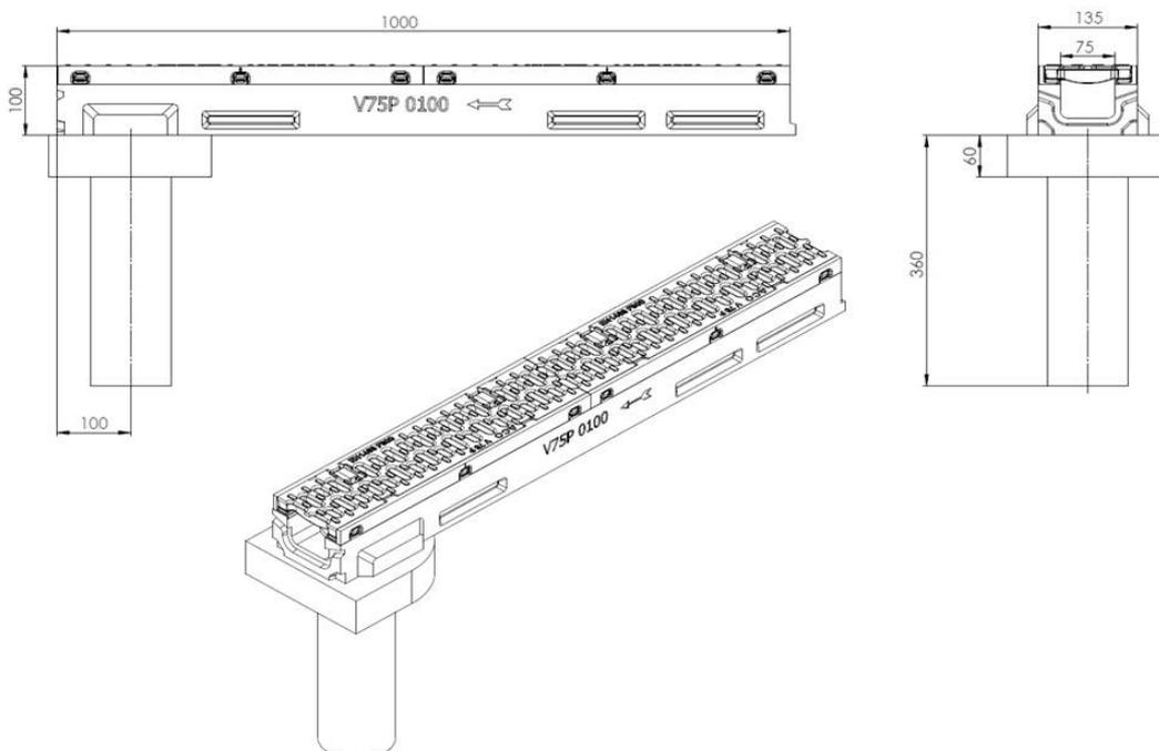
ACO DRAIN Powerdrain Rinnensystem für die Verwendung in LAU-Anlagen
