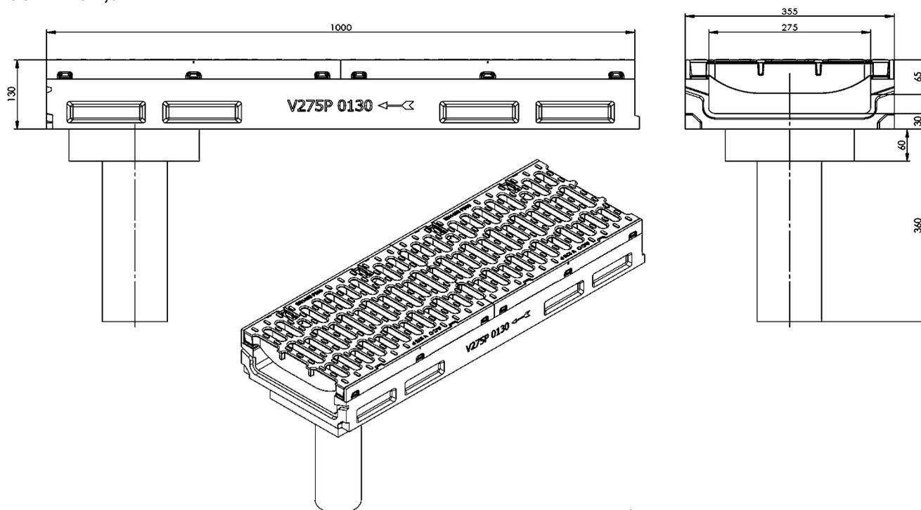
ACO DRAIN Powerdrain Rinnensystem für die Verwendung in LAU-Anlagen
