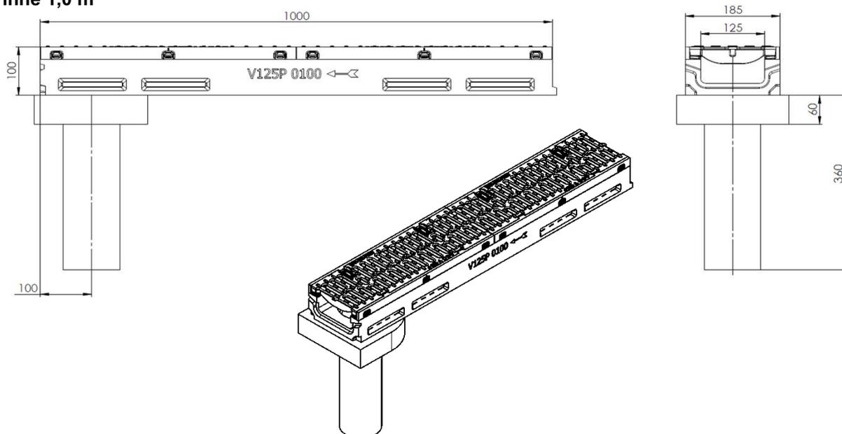
ACO DRAIN Powerdrain Rinnensystem für die Verwendung in LAU-Anlagen
