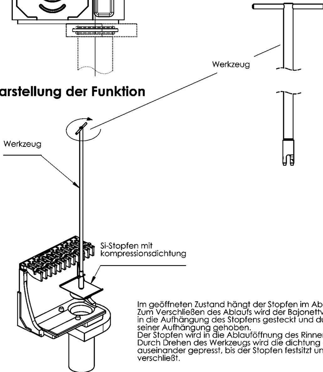
Im geöffneten Zustand hängt der Stopfen im Abdeckrost.
