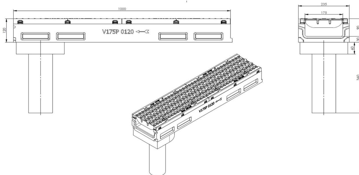
ACO DRAIN Powerdrain Rinnensystem für die Verwendung in LAU-Anlagen
