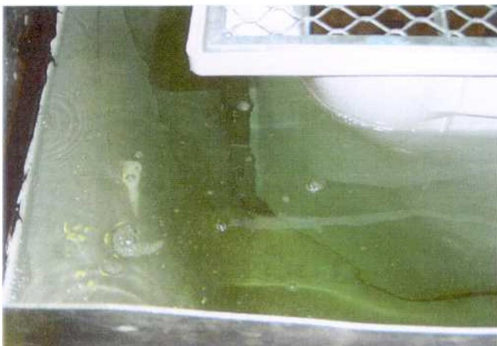
Bild 2: ACO Allround Lichtschacht 100 x 130 x 40 während der Prüfung der Druckwasserdichtigkeit
