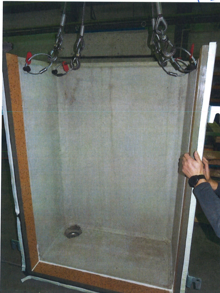
Bild 1: druckwasserdichter Verschluss der Ablauföffnung
