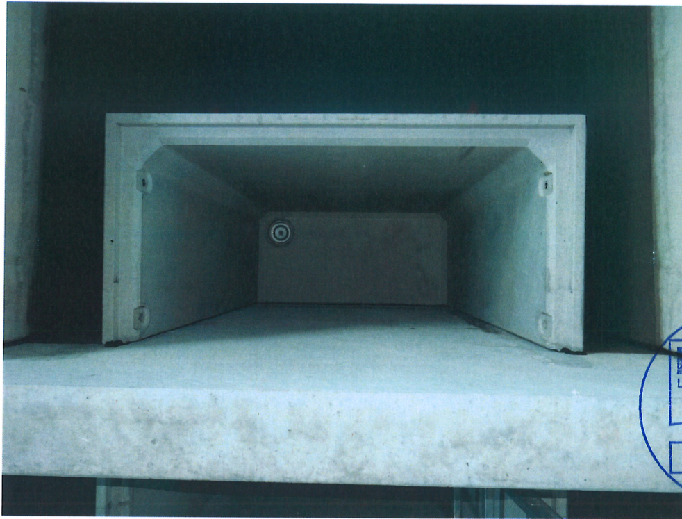
Bild 7: ACO Betonlichtschacht 1020 x 1500 x 500 während der Dichtigkeitsprüfung
