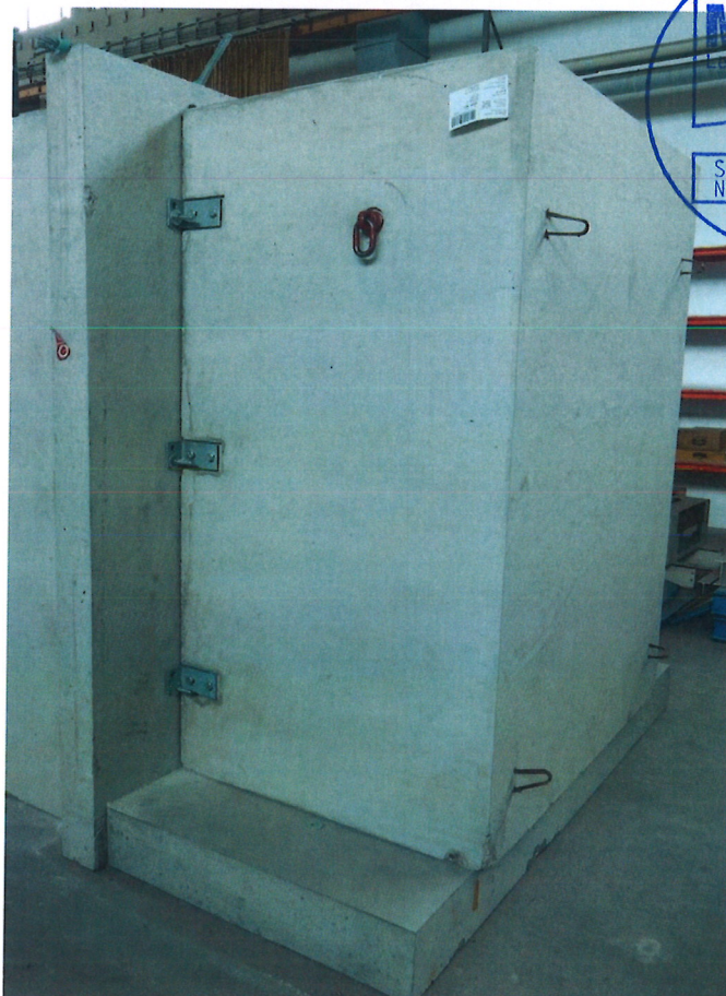
Bild 6: für die Dichtigkeitsprüfung über dem ACO Betonlichtschacht montierter Beton- Großlichtschacht
