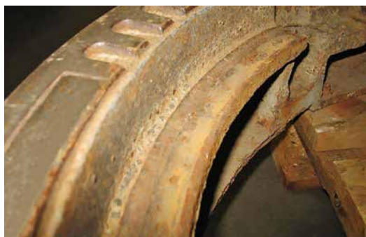
Der Deckel hat sich in die Auflagefläche des Rahmens eingearbeitet.
