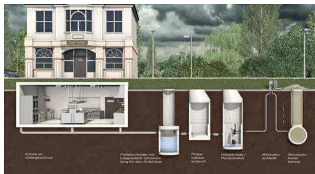
Beispiel für eine Fettabscheideranlage mit Rückstausicherung (Grafik: Mall)
