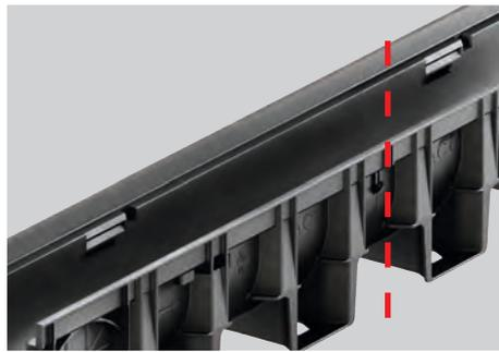
Praktisch ist die Teilbarkeit der 1-Meter-Elemente: Trennt man die ACO XtraDrain an der vorgezeichneten Schnittführung, ist sie auch als 0,5-Meter-Element einsetzbar.
