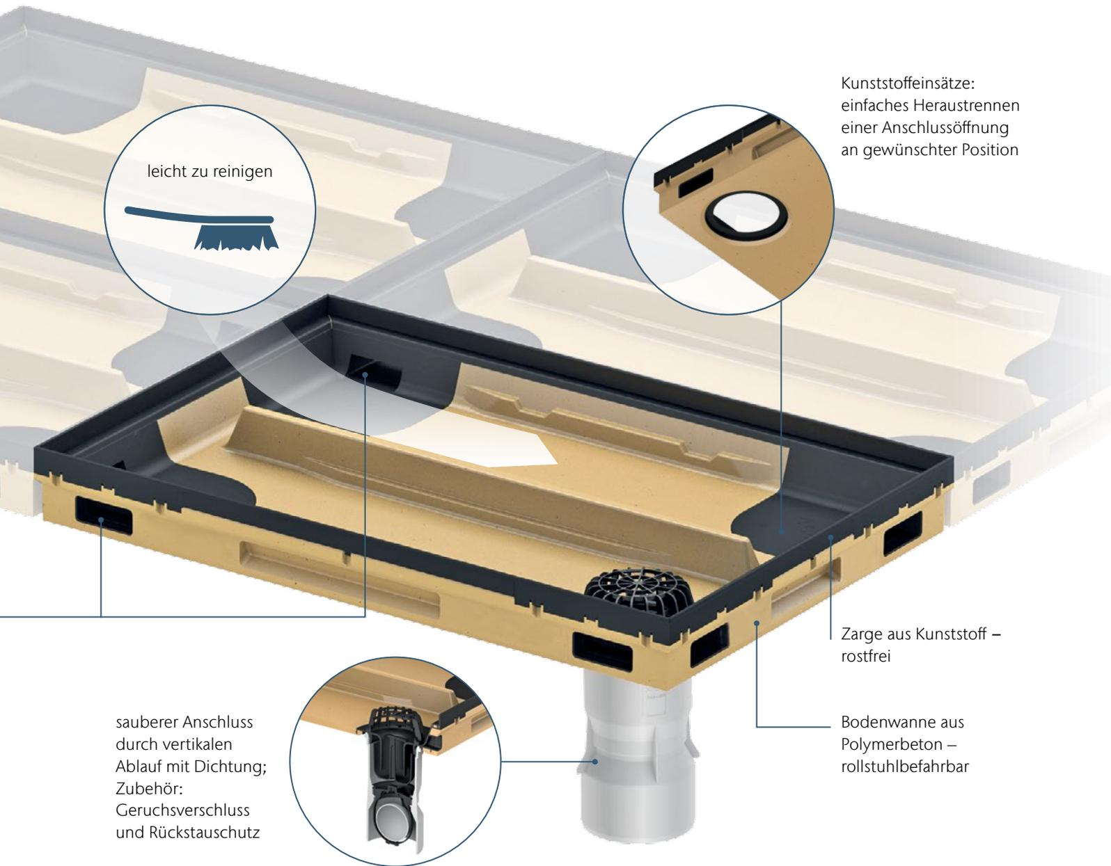
sauberer Anschluss durch vertikalen Ablauf mit Dichtung; Zubehör: Geruchsverschluss und Rückstauschutz
