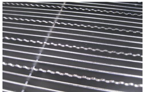
Alle Abdeckungen haben einen Rutschwiderstand von mindestens R10, mit eingearbeitetem Zackenkamm bis R12 und entsprechend der Richtlinie BGR 181.
