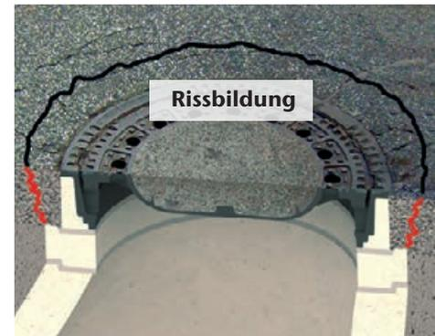
Durch Schwingungen erzeugte Risse an herkömmlichen Schachtabdeckungen
