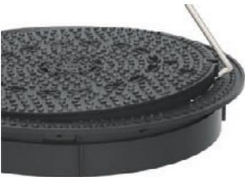
Bedienungsschlüssel an einer der zwei Entriegelungsöffnungen am Rahmen ansetzen und mit einer Hebelbewegung nach außen den Deckel entriegeln
