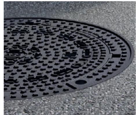
ACO Schachtabdeckungen Multitop sind auch als einwalzbares System Bituplan erhältlich. Bituplan-Abdeckungen werden nicht direkt auf den Schachtkopf gesetzt, sondern oberflächenbündig in den Straßenbelag eingewalzt oder -gerüttelt. Dadurch ist ein exakt flächenbündiger Einbau gewährleistet.
