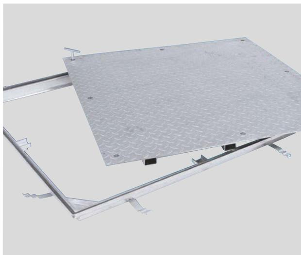
Access Cover Solid Schachtabdeckungen bestehen aus einem Rahmen und einer Deckelplatte aus verzinktem Stahl mit geringer Bauhöhe. Die Deckelplatte ist aus rutschfestem Tränenblech. Die Abdeckungen können sowohl im Außenbereich (z.B. Industrie- und Gewerbeanlagen, Verkehrsflächen) als auch im Innenbereich eingesetzt werden.
