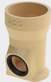
Ablaufkörper Langform in Verbindung mit Oberteil, mit Anschluss für KG-Rohre DN/OD 110, mit LLD 240x240x360 mm Art.-Nr. 319605
