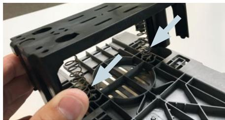
Federn positionieren und die Verstelleinheit in die entsprechenden Aufnahmen drücken
