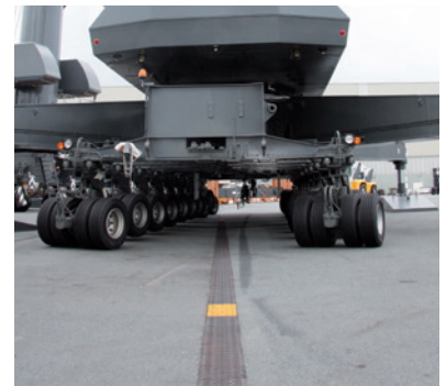
ACO PowerDrain eingebaut in Logistikflächen
