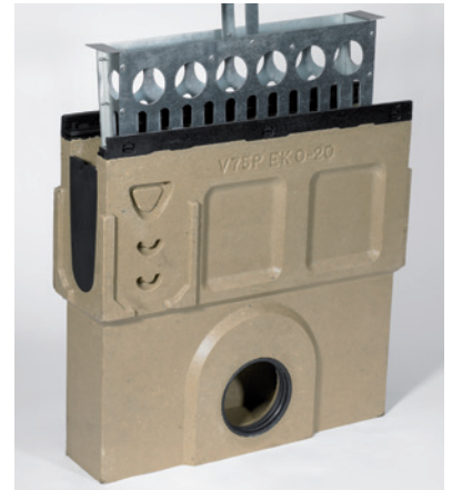
ACO DRAIN® PowerDrain Einlaufkasten V 75/100 P mit Schlammeimer stahlverzinkt, mit ausschneidbarer Anschlusschablone, mit integrierter Lippenlabirinthdichtung (wahlweise mit DN/OD 110 oder 160)
