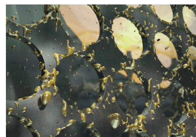
Kleine Öltröpfchen, die nicht infolge ihrer Dichtedifferenz zum Wasser abgeschieden werden, haften an das Koaleszenzelement an. Sobald die Haftigkeit des sich bildenden Ölfilm überschritten ist, lösen sich große Öltröpfchen wieder ab, schwimmen auf und sind somit abscheidbar.
