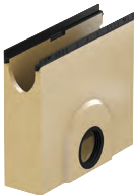
Einlaufkasten aus Polymerbeton mit Kunststoffkante, Bauhöhe 450 mm, DN/OD 110 oder 160
