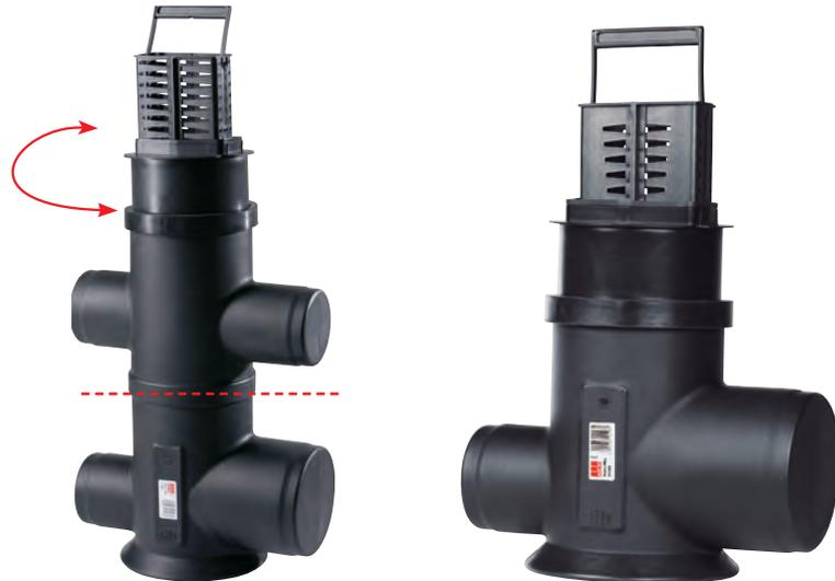
Ablaufschacht mit Schmutzfangemier und Ablaufadapter zum Anschließen senkrecht unterhalb der Rinne. Die runde Form ermöglicht ein einfaches Ausrichten nach der Grundleitung. Seitliche Abgänge DN/OD 110 und DN/OD 150
