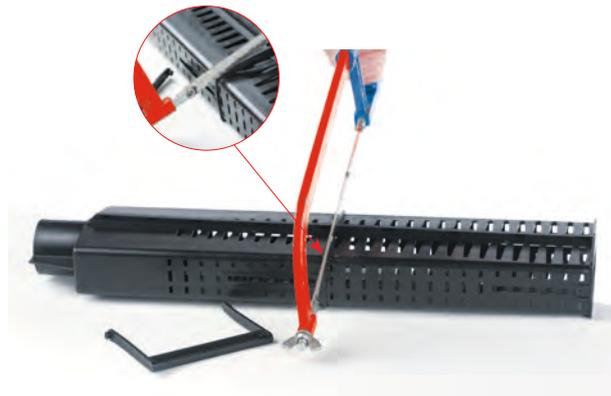
Die Anpassung des Schmutzfangemiers erfolgt durch Trennen oberhalb des mittleren Stegs. Den Henkel aus dem abgetrennten Oberteil herausdrücken und in die Führung des verkürzten Eimers einklicken
