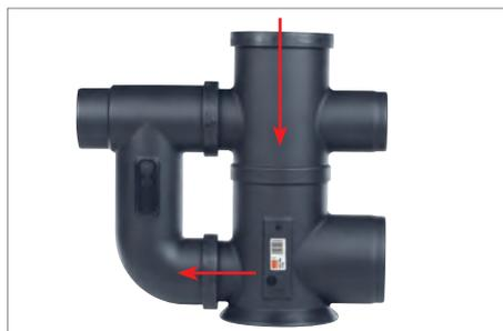
Geruchsverschluss aufstecken und den oberen Abgang von innen mit dem mitgelieferten Stopfen verschließen. Zur Reinigung des Geruchsverschlusses den Verschlussstopfen entfernen. Wir empfehlen, zweimal jährlich eine Inspektion des Rinnenstrangs durchzuführen
