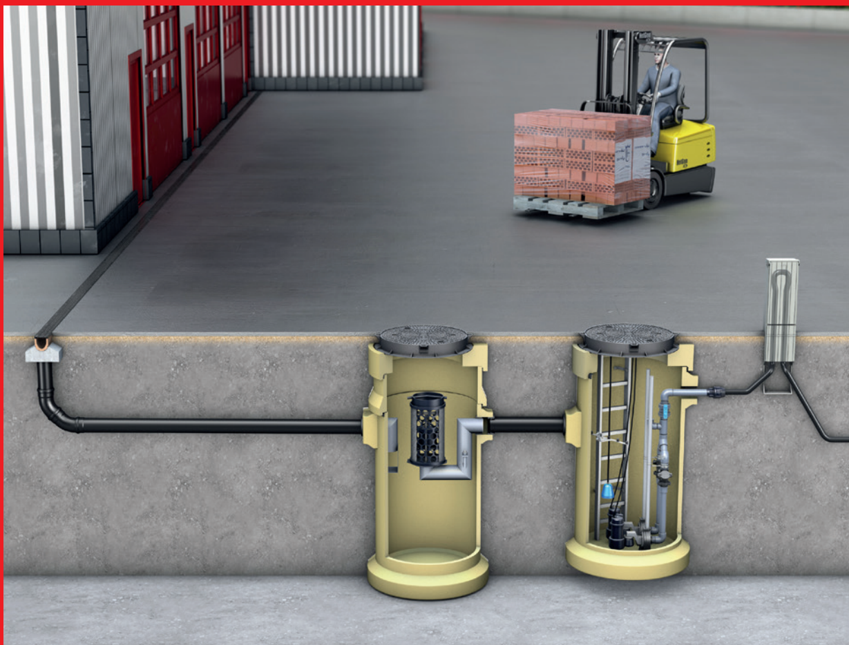
Entwässerung einer Logistikfläche über Entwässerungsrinne ACO DRAIN® PowerDrain, Leichtflüssigkeitsabscheider Oleopator Pro und Pumpstation Powerlift Pro mit Probenahmemöglichkeit.
