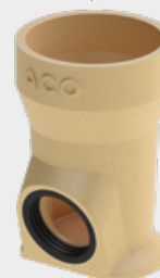
D 400 Ablaufkörper Langform in Verbindung mit Oberteil, mit Anschluss für KG-Rohr DN/OD 110, mit Lippen- labyrinthdichtung
