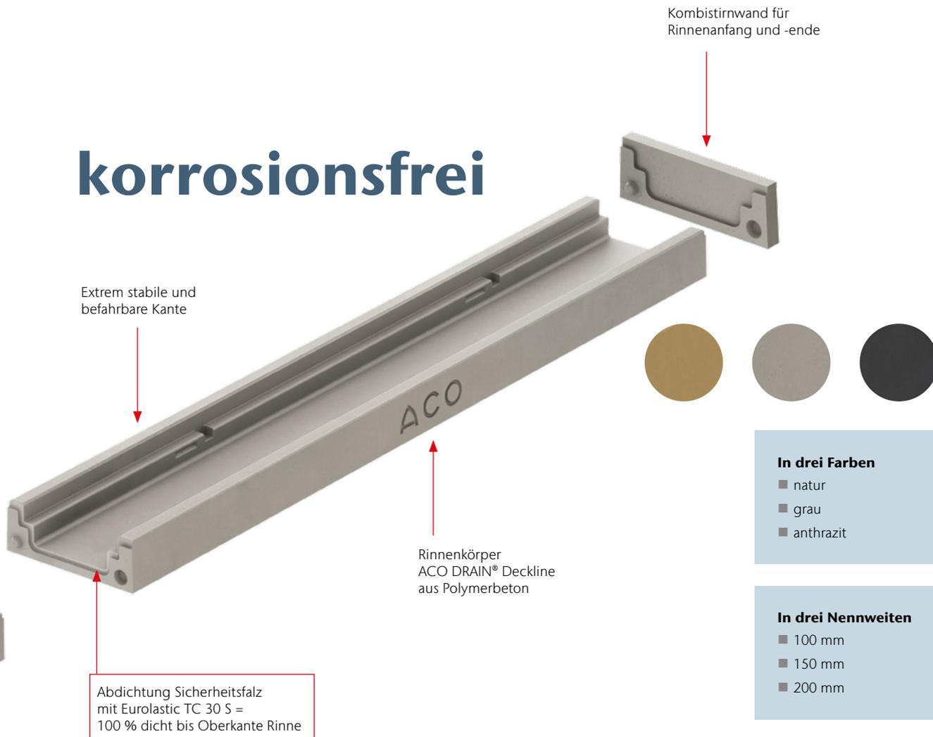
Die Rinnenkörper sind an beiden Rinnenenden mit dem **ACO Sicherheitsfalz** ausgestattet, eine Verlegerichtung ist hierbei nicht zu beachten. Der Sicherheitsfalz wird über die befahrene Kante nach außen geführt, dies ermöglicht ein sicheres und technisch einwandfreies nachträgliches Abdichten.
