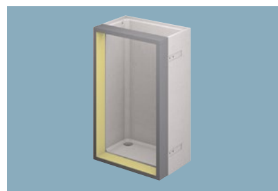
Betonlichtschacht in druckwasserdichter Ausführung mit umlaufend aufgebrachtener Dämmrahmen zum Aufstapeln eines weiteren Schachtes mit angeschraubter Hinterfüllplatte
