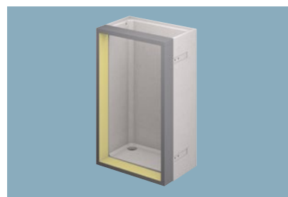
Betonlichtschacht in druckwasserdichter Ausführung mit umlaufend aufgebrachten Dämmrahmen zum Aufstapeln eines weiteren Schachtes mit angeschraubter Hinterfüllplatte
