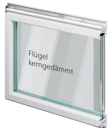
3-fach Wärmeschutzverglasung Ug-Wert = 0,6 W/(m 2 K) passivhaustauglich
