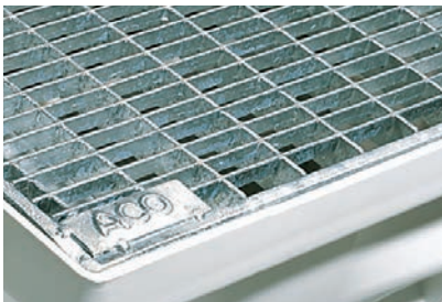
Maschenrost, Maschenweite 30 x 10 mm, be- gebar bis 1,5 kN, befahrbar, Radlast bis 9 kN
