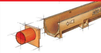
Anschlusslösung für Flächen mit geringem Laub- und Schmutzanfall oder bei flachen Einbaumöglichkeiten
