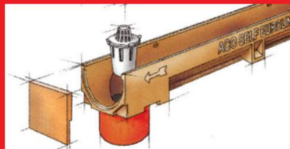
Anschluss an Grundleitung über Geruchsverschluss und Rohrstützen
