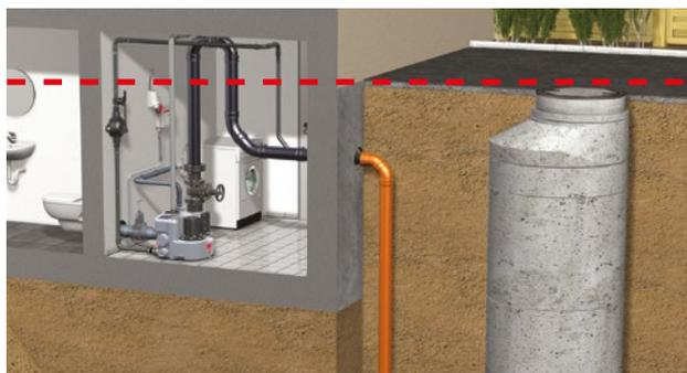
Schutz gegen Rückstau bei Gefälle zum Kanal durch eine Abwasserhebeanlage in Mehrfamilienhäusern, Gewerbeobjekten und Einfamilienhäusern mit Einliegerwohnung
