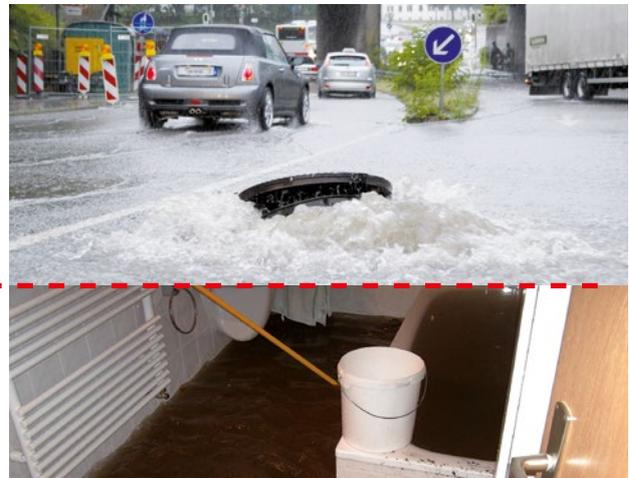
Die Rückstauenebene ist die höchste Ebene, bis zu der das Abwasser in der Entwässerungsanlage ansteigen kann, das ist in der Regel bis zur Straßenoberkante. Ab dieser Höhe verteilt sich rückstauendes Abwasser auf der Oberfläche im Gelände. Die Rückstauenebene ist in der Ortssatzung definiert.
