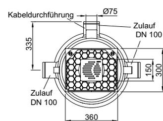
Sinkamat-K mit Bodenablauf und Geruchsverschluss, Abdeckung 360 x 300 mm
