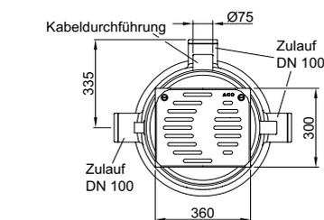
Sinkamat-K mit geschlossener Abdeckung, 360 x 300 mm
