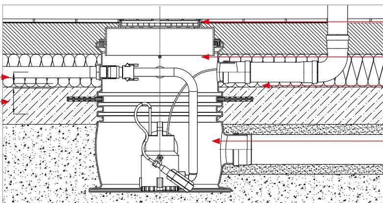
Teleskopisch verstellbares Aufsatzstück mit Wendeplatte K3
