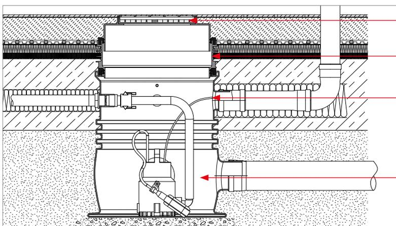
Teleskopisch verstellbares Aufsatzstück mit Wendeplatte K3
