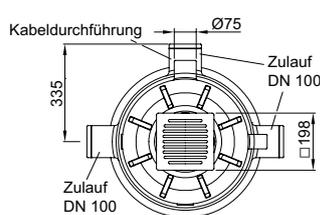
Sinkamat-K mit Aufsatzstück ohne Geruchsverschluss, 198 x 198 mm
