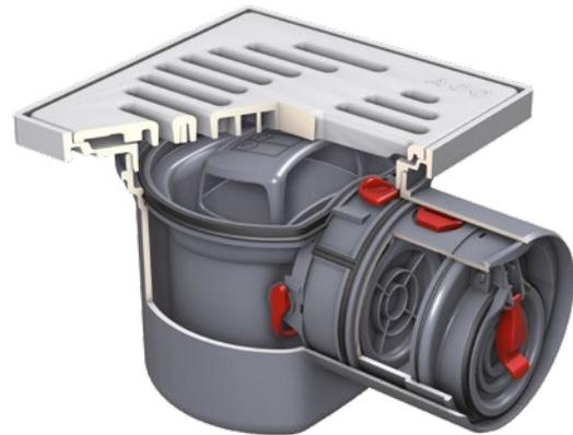
Der Kellerablauf Junior, Typ 5, verfügt über eine Rückstaeinheit mit zwei Klappen inklusive Notverschluss und wird in der Bodenplatte eingebaut.
