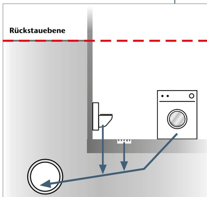
Das anfallende Abwasser kann mit Gefälle zum Kanal abgeleitet werden. Die Ablaufstelle befindet sich aber unterhalb der Rückstau-ebene und ist im Fall von Rückstau gefährdet.
