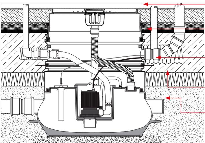
Teleskopisch verstellbares Aufsatzstück mit integriertem Bodenablauf (Sperrwasserhöhe= 50 mm)
