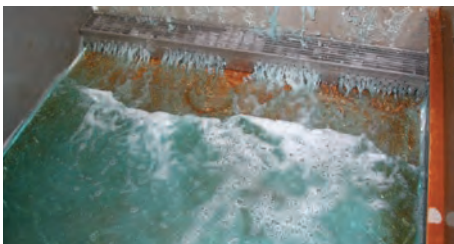
Prüfung des Rinnenkörpers mit Maschenrost 30 x 10 mm, freier Ablauf wie geständerter Belag
