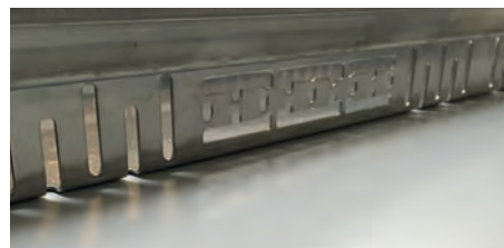
Stichkanalanschluss alle 50 cm
