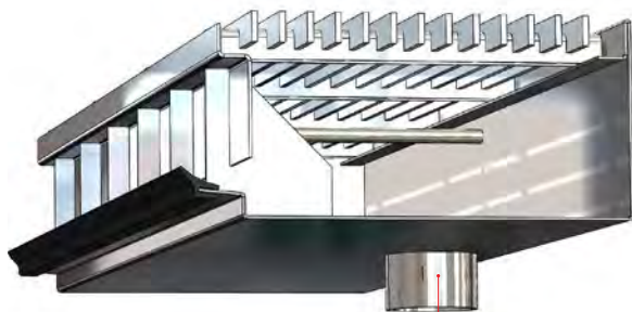
Anbindung und Entwässerung des Schwellsystems
