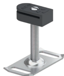
Typ 2 Höhenstellbereich Frameline: 80-100 mm Frameline C: 90-110 mm
