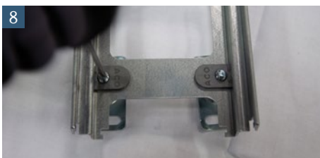
Die Stellfüße können separat eingestellt werden
