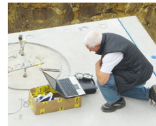
Druckluftprüfung auf Dichtheit
