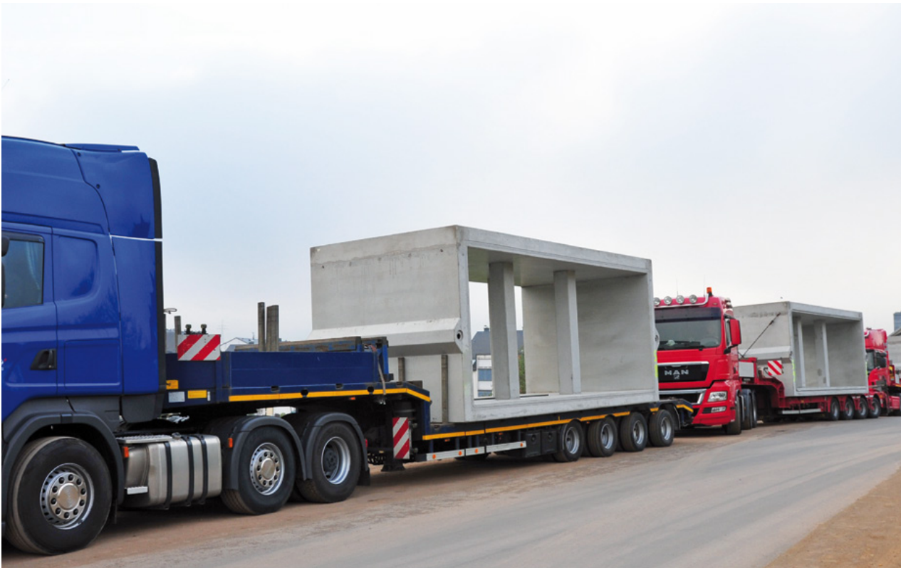
Transport des Großbehältersystems
