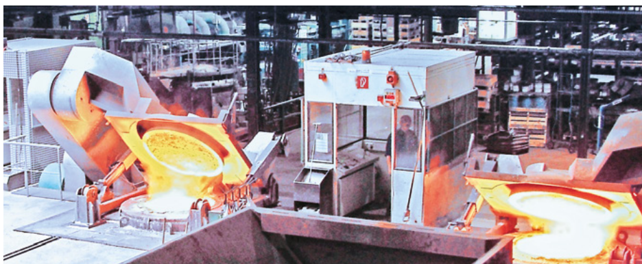
Moderne Mittelfrequenz-Induktions-Schmelzöfen, ACO Kaiserslautern
