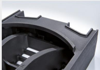
Die große Aufstandsfläche an der Rahmenunterseite verringert die Flächenpressung im Mörtelbett und gewährleistet einen dauerhaften Lastabtrag
