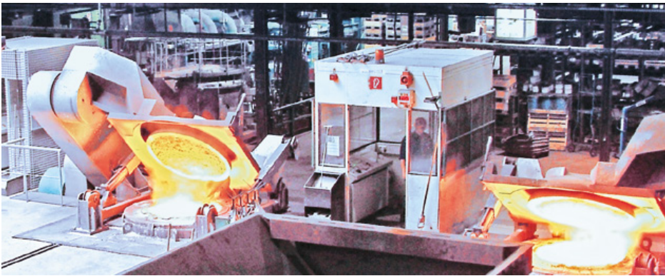
Moderne Mittelfrequenz-Induktions-Schmelzöfen, ACO Kaiserslautern
