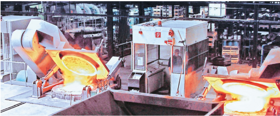
Moderne Mittelfrequenz-Induktions-Schmelzöfen, ACO Kaiserslautern
