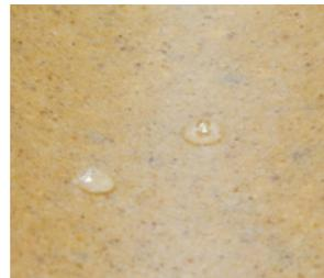
Durch **ACO Polymerbeton**, einen Werkstoff mit Wassereindringtiefe 0 mm, ist der ganze Rinnenstrang wasserdicht.
