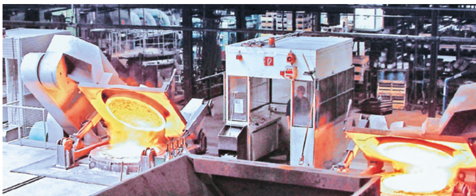
Moderne Mittelfrequenz-Induktions-Schmelzöfen, ACO Kaiserslautern
