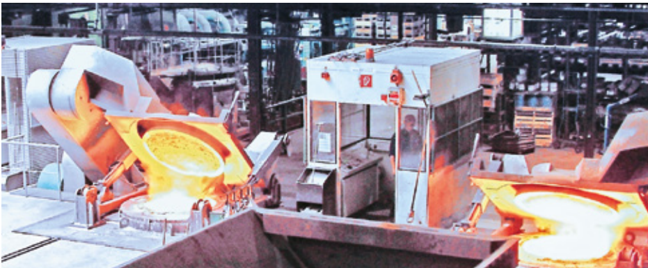
Moderne Mittelfrequenz-Induktions-Schmelzöfen, ACO Kaiserslautern
