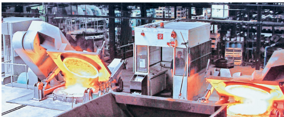
Moderne Mittelfrequenz- Induktions-Schmelzöfen, ACO Kaiserslautern
