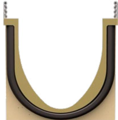
Der V-Querschnitt – verbesserte Hydraulik und Stabilität
