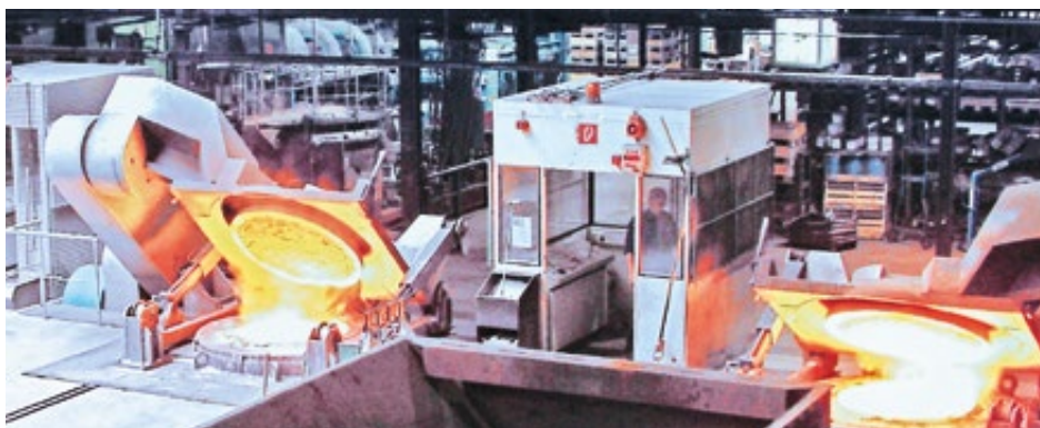
Moderne Mittelfrequenz- Induktions-Schmelzöfen, ACO Kaiserslautern
