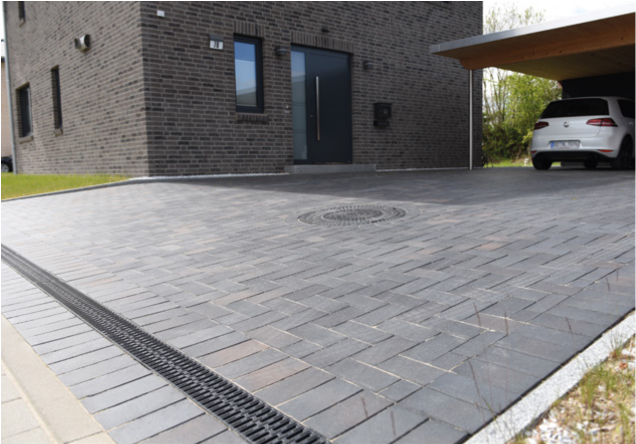
Kunststoffrinne Hexaline mit Microgrip-Rost
