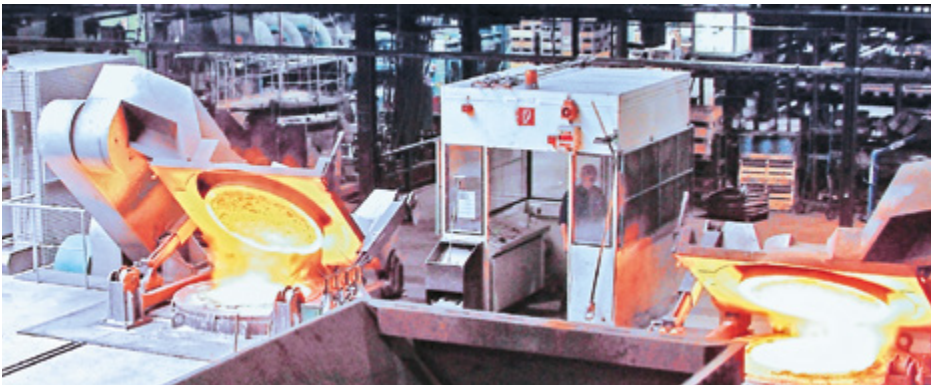
Moderne Mittelfrequenz-Induktions-Schmelzöfen, ACO Kaiserslautern
