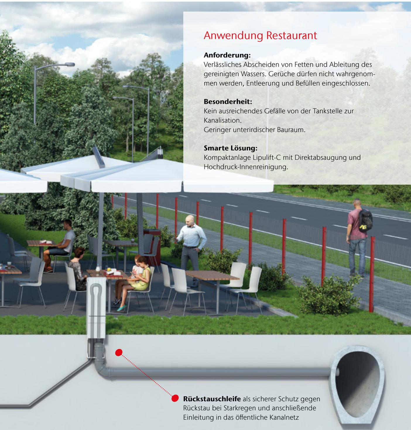
**Rückstauschleife** als sicherer Schutz gegen Rückstau bei Starkregen und anschließende Einleitung in das öffentliche Kanalnetz
