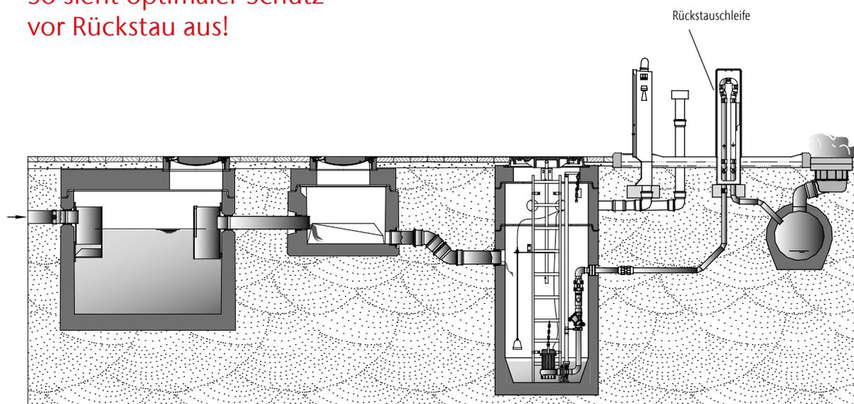
Durch die der Abscheideranlage nachgeschaltete Pumpstation wird das Wasser rückstaufrei der Kanalisation zugeführt
