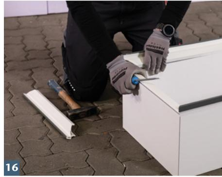
16 Rostauflegeprofil von Aufstockelement entfernen.
