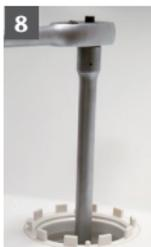
Die Rückstaeinheit von oben in den Grundkörper führen. Hierbei ist ein leichter Widerstand zu überwinden, wenn der Kugelkäfig durch die Einschnürung im Grundkörper geschoben wird. Dabei nicht drehen! Beim Einschrauben auf den korrekten Sitz des Gewindes achten. Drehmoment: 5 Nm
