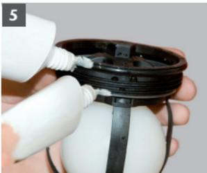
Nach dem Reinigen alle Dichtungen auf Reinheit und Beschädigungen untersuchen. Beschädigte oder fehlende Dichtungen führen zur Fehlfunktion der Rückstaeinheit. Beschädigte Dichtungen austauschen! Dichtungen an der Rückstaeinheit mit Gleitmittel bestreichen (wie bei Montage).
