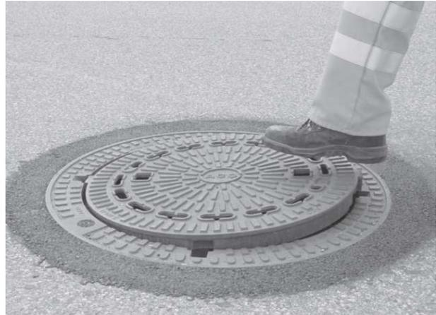
Anschließend Deckel mit einem senkrechten Tritt oder Stoß auf den über den Rahmen hinausragenden Teil des Deckels verriegeln. Die Verriegelung ist eingerastet, wenn Deckel und Rahmenoberseite umlaufend auf gleicher Höhe liegen.
