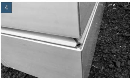
Die Aufstockelemente über das Nut- und Federsystem miteinander verklicken. Hier kann ein Hammer und eine Holzleiste (zum Schutz der Kunststoffteile) zur Hilfe genommen werden. Bitte wandseitig auf einer Seite beginnen und Stück für Stück die Verbindung herstellen.
